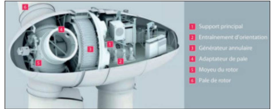
FIGURE 9 : COUPE DE LA NACELLE D'UNE ÉOLIENNE ENERCON
